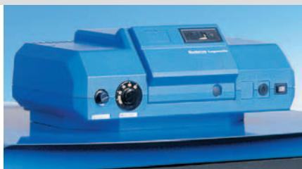
Система управления Logamatic 2112 была специально разработана для систем отопления с твердотопливными котлами. Учитывая специфику управления данными системами отопления, Logamatic 2112 имеет такие функции, как управление вентилятором в зависимости от температуры уходящих газов, управление котловым насосом и терmostатом ГВС. В Logamatic 2112 предусмотрен настраиваемый алгоритм защиты от перегрева котла.
