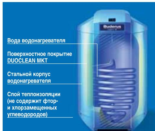
Стенки бака в водонагревателях Buderus выполняют две функции: стальная конструкция обеспечивает механическую прочность, а поверхностное покрытие служит для гигиены и защиты от коррозии.
