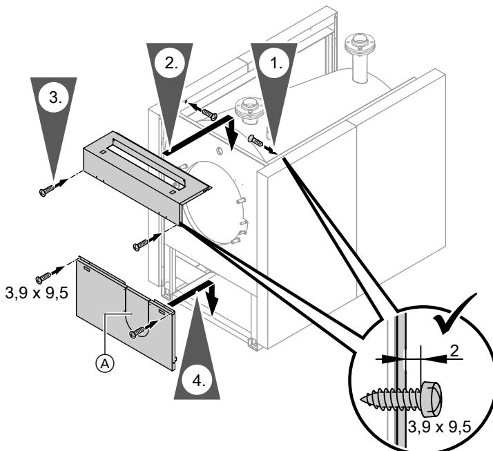
Полное ввинчивание винтов в верхнюю часть фронтальной панели облицовки производится только после установки датчика температуры котловой воды и чувствительного элемента (см. стр. 15).
