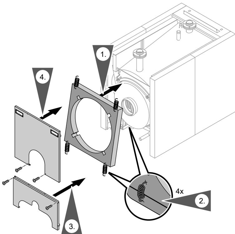
При необходимости выровнять боковые панели облицовки в соответствии с фронтальной и задней панелями облицовки. Для этого ослабить саморезы со сфероцилиндрической головкой на верхних крепежных планках.
