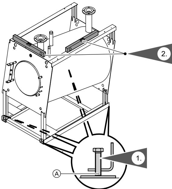
1. Ввинтить регулировочные винты сверху в шины основания.
