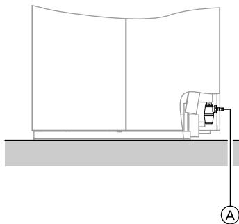
Проложить линию отвода конденсата с уклоном ниже уровня обратного подпора выходного коллектора уходящих газов.
