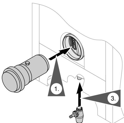
1. Вставить присоединительный элемент котла (принадлежность) до упора в патрубок уходящих газов.
