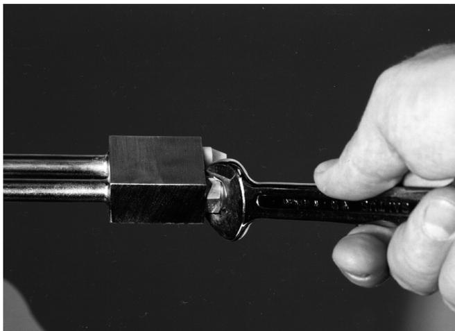
Выбранные форсунки ввинтить при помощи шестигранного ключа. Вильчатый гаечный ключ следует использовать как к контропору. Затем вплотную снова насаживается подпорный диск и затягивается до упора.
