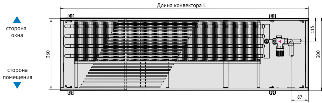
Вид сверху конвектора Ntherm Maxi 370 с роликовой решеткой, с U-образным бортом.
