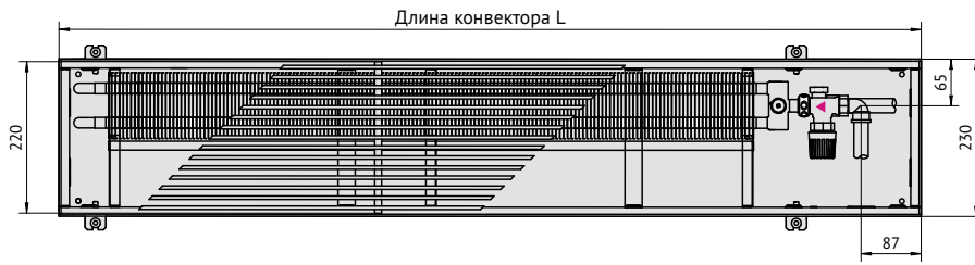
Вид сверху конвектора Ntherm Maxi 230 с роликовой решеткой, с U-образным бортом.
