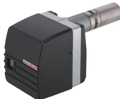
Vollautomatischer Ölbrenner geprüft und zugelassen nach DIN EN 267 für Heizöl EL gemäß DIN 51 603 mit Ölvorwärmung (Ausführung -V) und elektromotorisch gesteuertem Luftabschluss (Ausführung -L) und schadstoffarmer Verbrennung (Ausführung -BI NOx).
