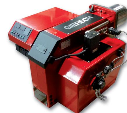
Vollautomatischer Ölbrenner in Monoblockausführung ausgestattet für einstufige Leistungsregelung (Ausführung -AE) oder für zweistufige Leistungsregelung mit elektromotorisch gesteuertem Luftabschluss (Ausführung -Z-L), geprüft und zugelassen nach DIN EN 267 für Heizöl EL gemäß DIN 51603.
