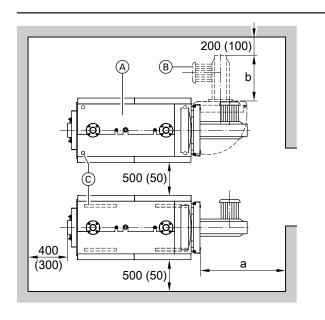
Для упрощения монтажа и работ по техобслуживанию необходимо соблюдение указанных размеров. При ограниченном пространстве для монтажа достаточно выдержать минимальные расстояния (указанные в скобках). В состоянии при поставке дверь котла открывается влево. Шарнирные болты можно переставить таким образом, чтобы дверь открывалась вправо.
