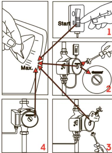
**6.1 В процессе выпуска воздуха необходимо предохранять электрические соединения от возможного попадания теплоносителя (воды)**
