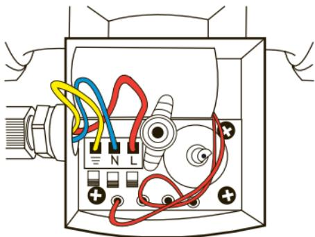
Электрическое соединение насоса необходимо выполнить по соединительной схеме, которая отображена на нижней стороне крышки мотора. Перед этим необходимо отвинтить верхнюю крышку.
