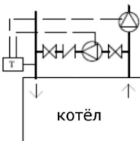
При запуске горелки, терmostат, установленный на возврате воды в котёл и тарированный на 55° С с обменным контактом, запускает в работу антиконденсационный насос до достижения установленной температуры, затем, одновременно выключается антиконденсационный котёл и включаются насосы установки.
