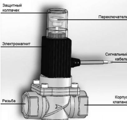
GV-90 - электромагнитный клапан, перекрывающий подачу газа, предназначен для безопасного использования бытовых газовых приборов в совместной работе с сигнализатором утечки газа.
