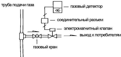
Для открытия клапана в ручном режиме необходимо снять защитный прозрачный колпачок и потянуть красный диск вверх до упора. После этого не забудьте установить защитный колпачок.
