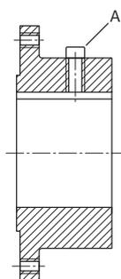
Fig. 15: Установочный винт А для осевой фиксации
