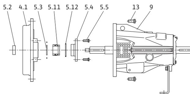
Fig. 26: Исполнение со скользящим торцевым уплотнением
