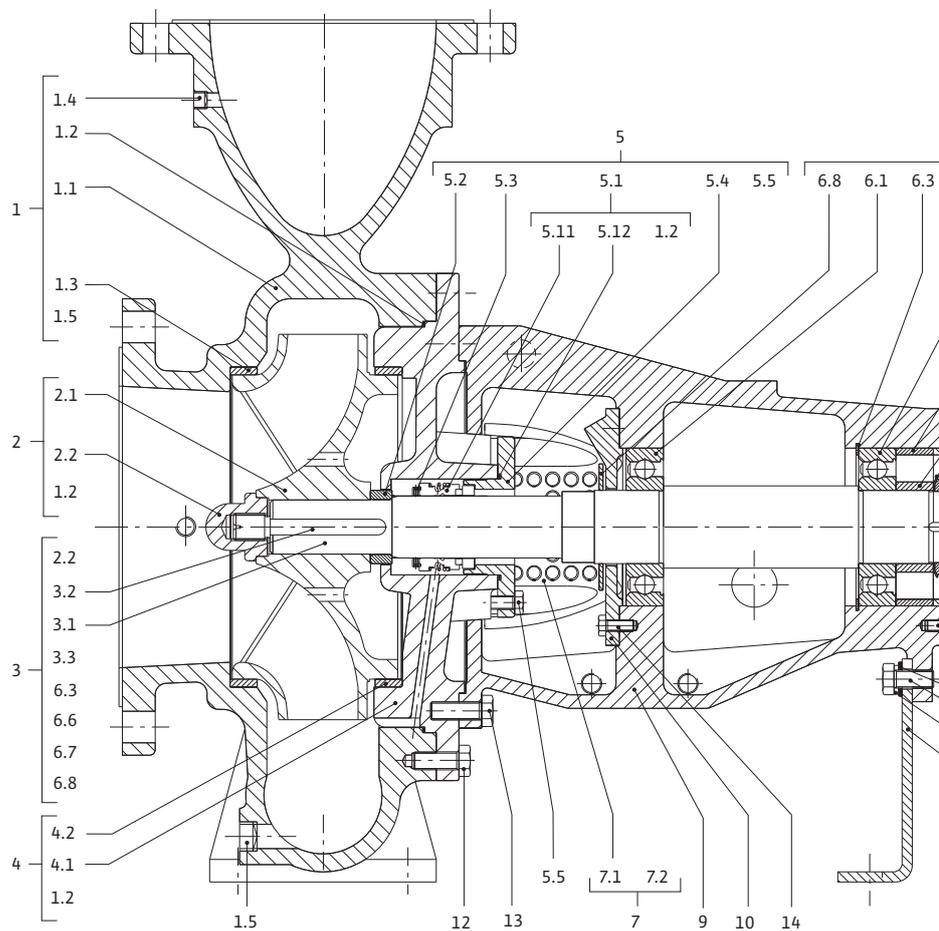
Fig. 37: Исполнение Wilo-CronoNorm-NLG со скользящим торцевым уплотнением
