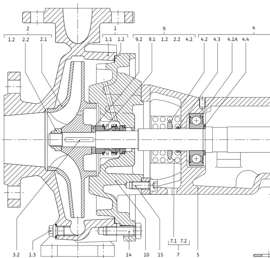
Fig. 35: Исполнение Wilo-CronoNorm-NL со скользящим торцевым уплотнением
