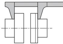
Fig. 13: Проверка осевой выверки при помощи штангенциркуля
