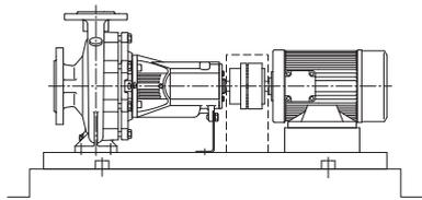
Fig. 5: Установка насоса на фундаменте
