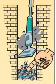
IT - Prerevedere una protezione contro la mancanza d'acqua per evitare il rischio di un funzionamento a secco (centraline elettroniche ES..M - ES..T, ESC..M - ESC..T).
